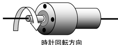
HA-655 ドライバの回転方向は、システムパラメータ→「08：回転方向指令」の設定で切り換えることができます。
